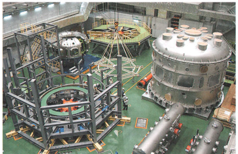
図3 KSTAR実験室。右側の円筒形の装置が断熱真空容器、その手前の2本の筒が真空排気装置のマニホールド、左の壁際に真空容器がみえている。
