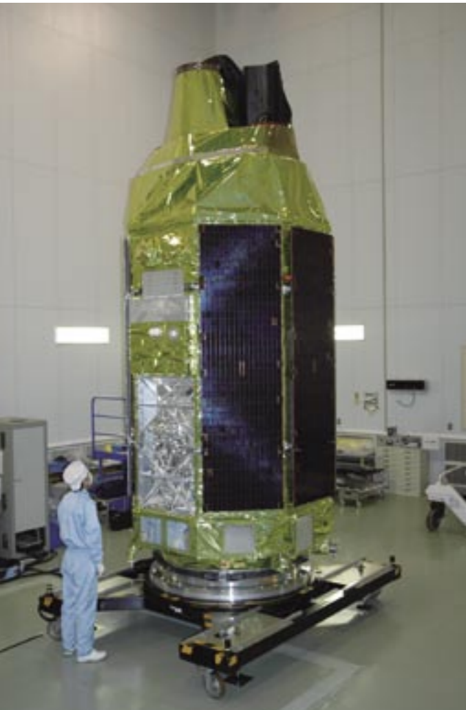
図1 打ち上げ前の「すざく」衛星。軌道上で、6枚の太陽電池パドルを展開し、望遠鏡の焦点距離を確保するために光学ベンチを1.5m展開した。
