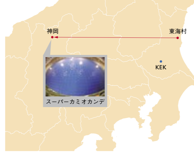
図2 T2K実験。J-PARCで生成した人工ニュートリノをスーパーカミオカンデに向けて発射し、ニュートリノ振動を詳しく調べる。
