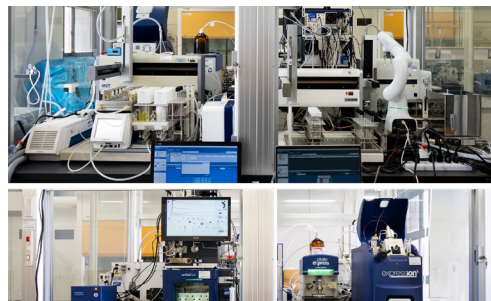
図：今回構築した自動有機合成システム 上段左：合成ゾーン 上段右：後処理・搬送ゾーン 下段左：単離精製ゾーン 下段右：分析・同定ゾーン
