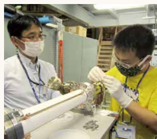
高速ビームキッカーの組み立て作業の様子
