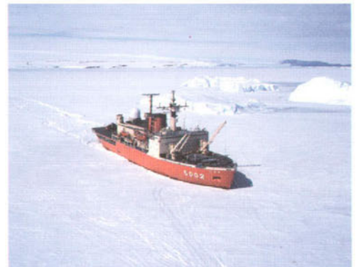
「しらせ」の船名は南極探検の偉業を成した白瀬矗（のぶ）中尉（1861～1946）に因んでつけられた。全長134m、幅28m、基準排水量約1万1700トン、最大速力約19ノット。1.5mの氷を3ノットで連続砕氷が可能である。乗組員約170名、観測隊員60名のほか、同行者が数名乗船する。
