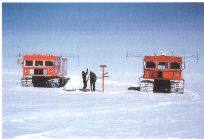
雪上車による氷床内部構造のレーダー観測。2台の雪上車の屋根に設置したアンテナから、真下の氷に向けて電波を放射し、跳ね返ってくる反射・散乱波を受信する。写真は、昭和基地と南極点のほぼ中間に位置する「ふじ峠」。
