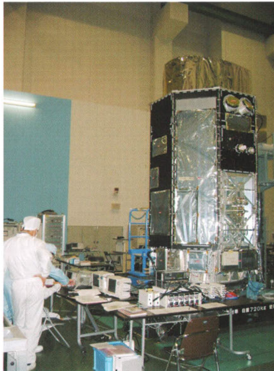
図4 現在開発が進められているASTRO-E2衛星の一次組み合わせ試験の一コマ。この試験は、衛星の各機器の製作が終わった段階で、いちど衛星を組み上げ、機械的・電氣的インターフェイスの確認や、基本的機能の確認を行うものである。
