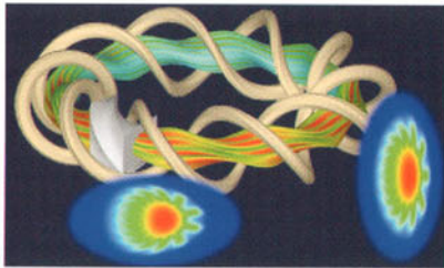
図2 LHDプラズマの非線形磁気流体シミュレーション(三浦英昭氏提供)。有限の電気抵抗と圧力勾配によって駆動される抵抗性バルーニングモードと呼ばれるMHD不安定性の成長により、歪んだプラズマ圧力分布が色の違いにより表されている。
