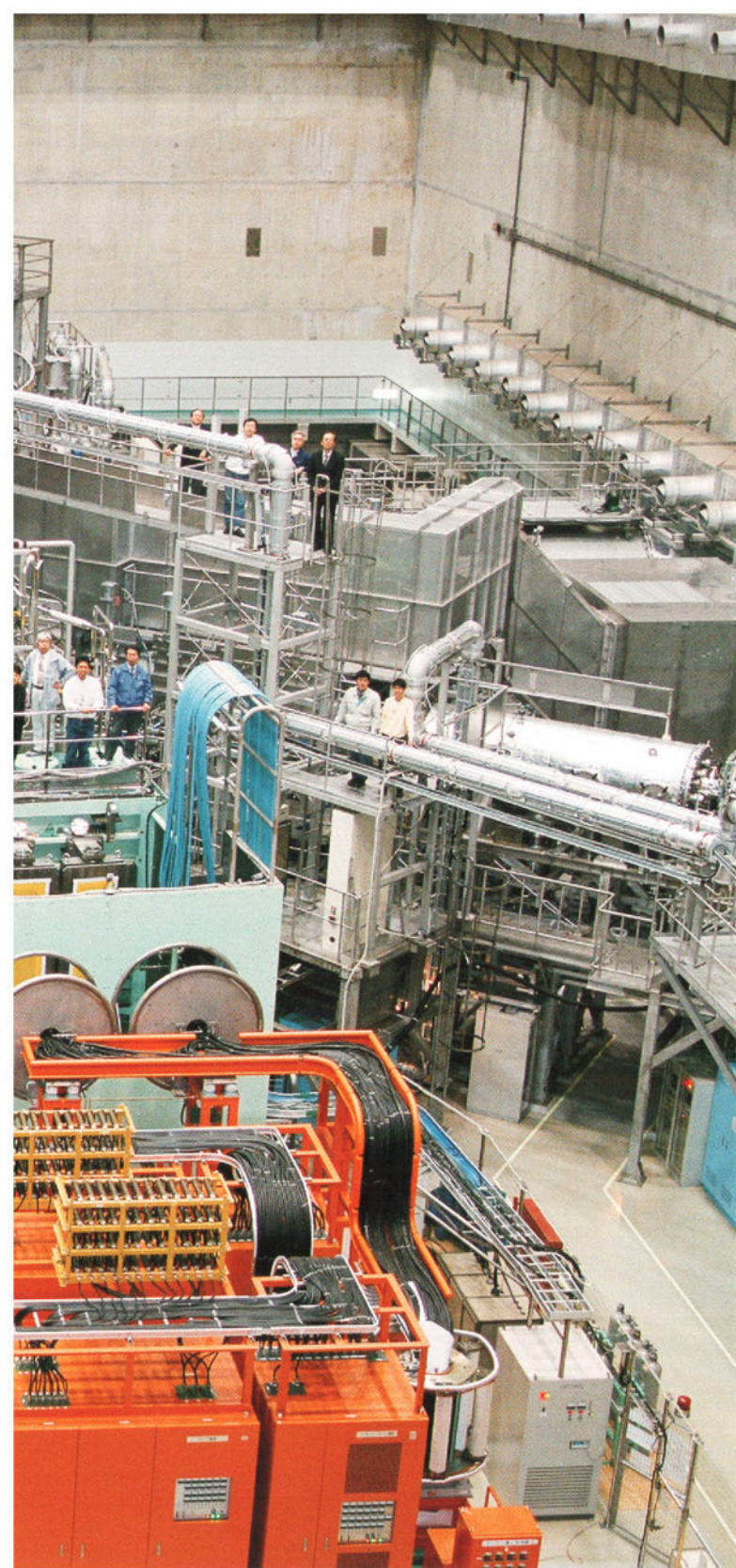
LHDを囲む研究者と技術者たち。中央の円形部分が装置本体で、プラズマの加熱装置や各種計測装置が放射状に設置されている。
