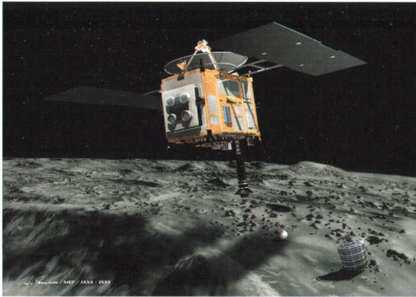
図3 小惑星にタッチダウンする「はやぶさ」(想像図)。探査機下面にサンプル採取用の筒が取り付けられている。小惑星表面にある球状物体はマーカー(着地目標点を示す人工目標)、手前は小型ロボットランダーMINERVA。
