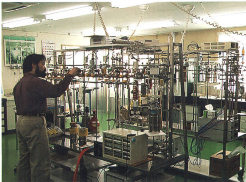
炭素14年代測定法に使う試料を精製する装置。木材や炭、紙などを起源にもつ遺物を試料に用いる。まずは試料の不純物や異物などを取り除いて精製をする。
